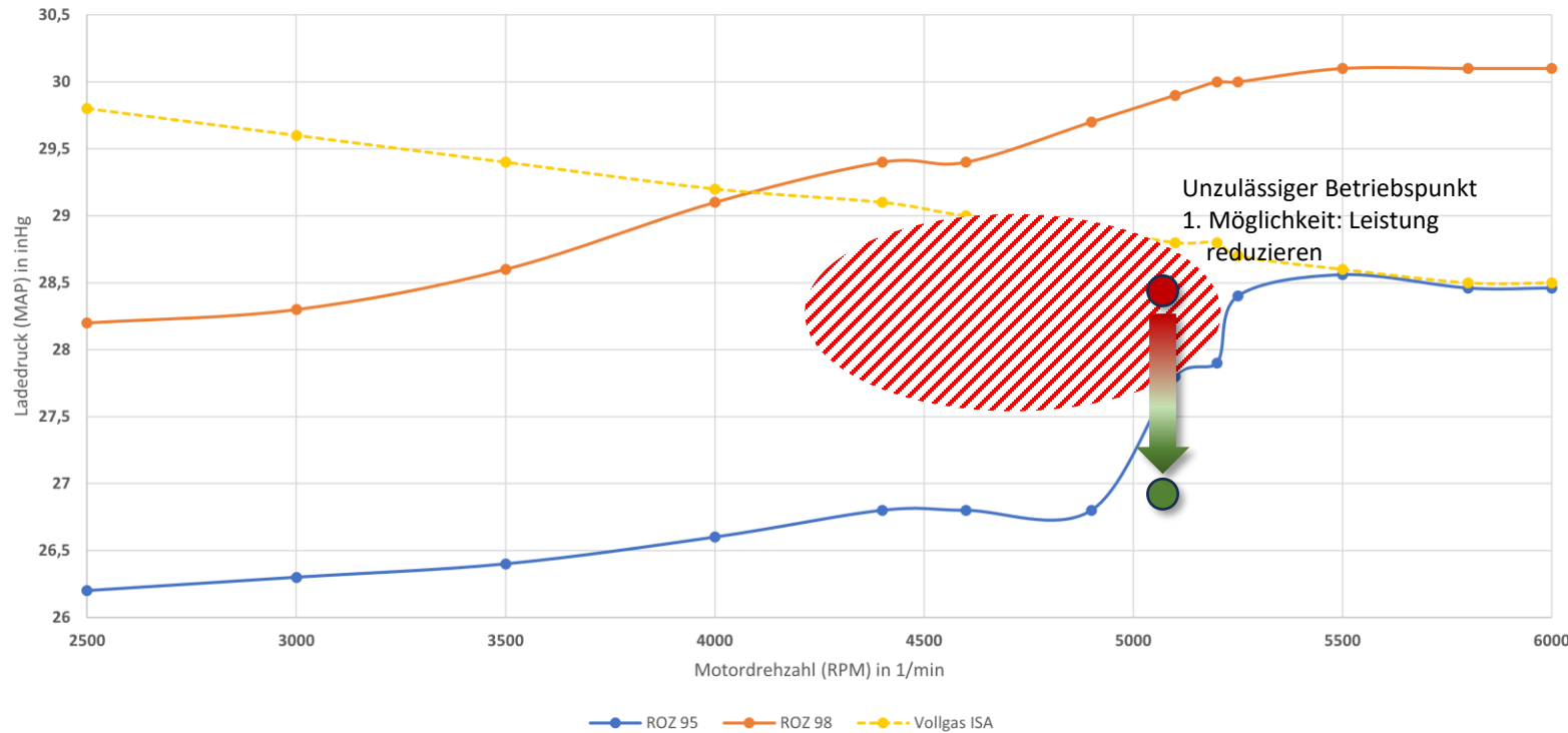
Klopfgrenzen 912 S/ULS abhängig von der Klopfestigkeit des Kraftstoffs
