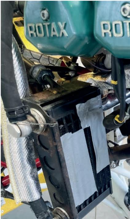
**Abgeklebter Ölkühler für den Winterbetrieb an einer FK9. Der Motor darf dadurch unter keinen Umständen überhitzen, um einen Ausfall im Betrieb zu vermeiden.**
