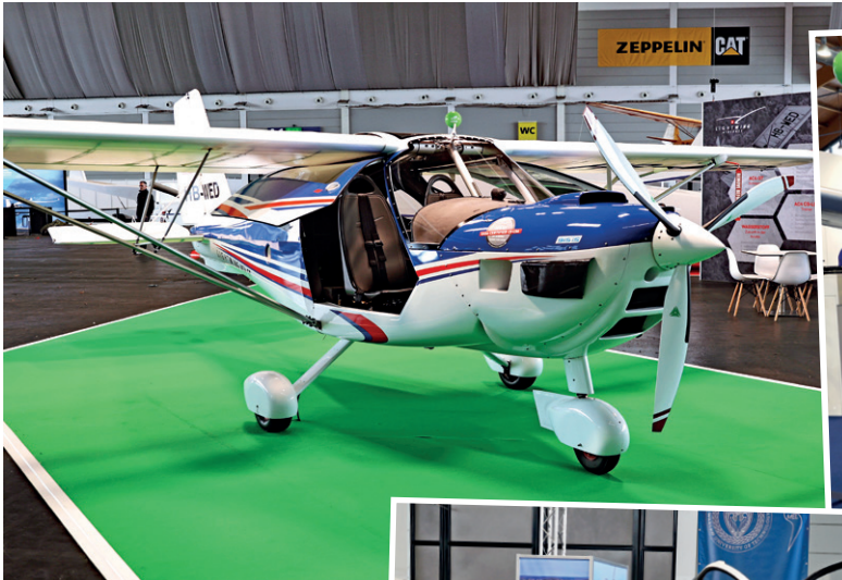
▲ Die Lightwing AC4 GT aus der Schweiz kann Segelflugzeuge bis 850 Kilogramm auf Höhe bringen
