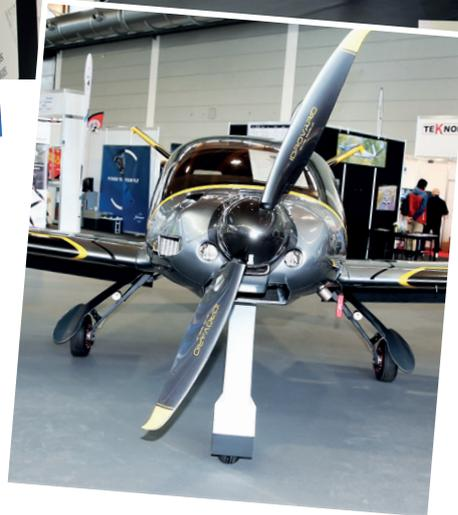
◀ Das 450 km/h ultraschnelle Highend-UL Risen 915iS Super Veloce von Alberto Porto mit Einziehfahrwerk und markantem V-Leitwerk
