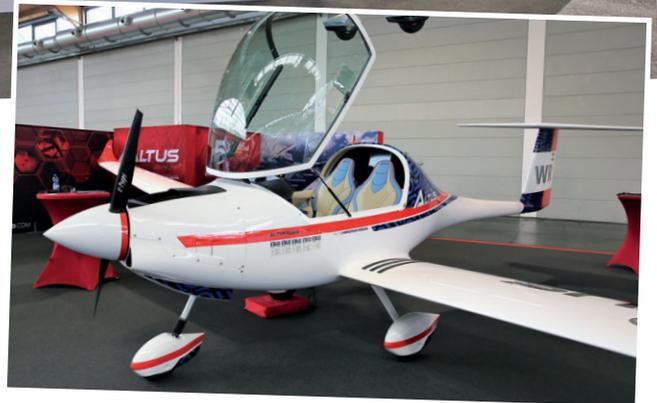
▲ Der Altus aus Ungarn ist mit elf und mit fünfzehn Meter Spannweite erhältlich
