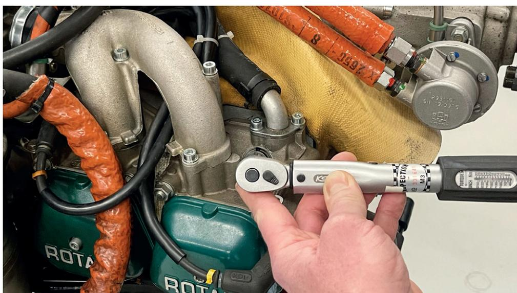
◀ Die Zündkerzen werden bei den meisten Rotax-Modellen bei kaltem Motor mit einem Drehmoment von 20 Nm festgezogen
