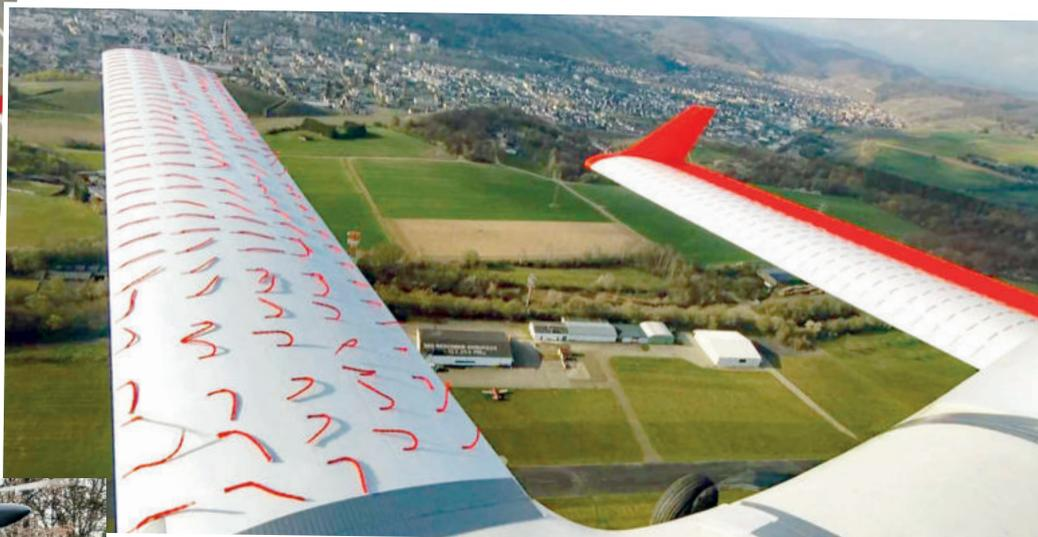
▲ Videobeweis der mitfliegenden GoPro: Während sich bei Minimalfahrt die Strömung am Kopfflügel von innen langsam ablöste, lag sie am gesamten Hauptflügel noch perfekt an. Obwohl der Kopfflügel nicht geschränkt ist, blieb die Strömung im äußeren Drittel ebenfalls gesund.
