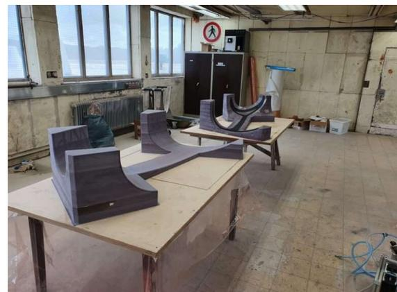
In die fertigen Formen wurde das in getränkte Gewebe eingelegt und unter Vakuum ausgehärtet. Nach dem entformen und besäumen konnten beide Hälften (zunächst noch voneinander getrennt) eingeklebt und schließlich über eine Schäftung verbunden werden.
