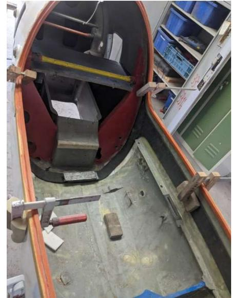
Zum Schutz vor scharfkantigen oder spitzen Bruchstücken der Kohlefaserstruktur wurde am Ende eine Lage Kohle-Aramidgewebe über die komplette Nachrüstlösung gelegt.
