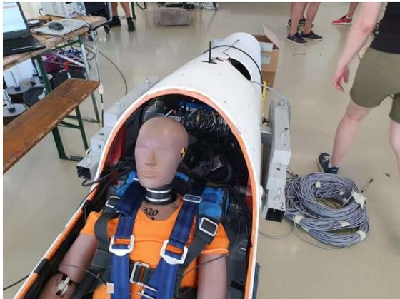
Insgesamt wurde der Versuch von 8 Highspeedkameras aufgenommen. Zwei Kameras wurden von der Firma Imaging Solutions zur Verfügung gestellt und bedient. Zwei weitere Kameras wurden uns vom Institut für Strömungsmechanik in Braunschweig geliehen. Die Erfassung der Deformation des Rumpfes erfolgte schließlich über 2x2 Kameras der Firma Me:go.
