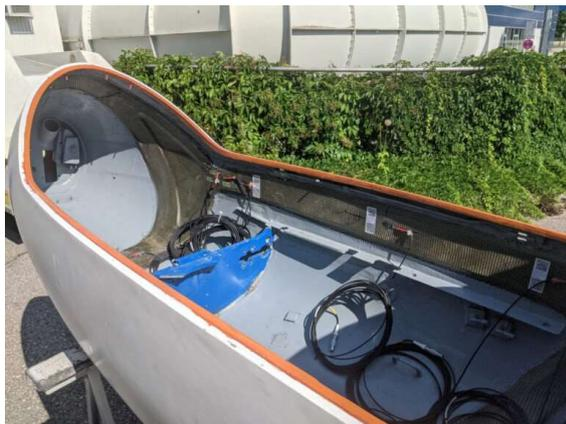
In einem letzten Schritt wurde der Rumpf getempert und optisch etwas hergerichtet. Außerdem wurden Halterungen für Ersatzmassen und Messtechnik vorbereitet
