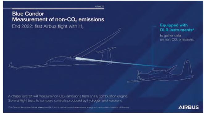
**Blue Condor** ist ein von Airbus UpNext initiiertes Projekt, mit dessen Hilfe die Auswirkungen der Wasserstoffverbrennung in großen Höhen analysiert werden soll. Das Ergebnis der Untersuchungen wird im Vorfeld der ZEROe-Demonstrator-Flugtests wichtige Informationen über die CO<sub>2</sub>-freien Emissionen der zukünftigen Luftfahrt liefern, auch, indem es zu weiteren Aufschlüssen über Bildung, Zusammensetzung und Eigenschaften von Kondensstreifen verhilft.
