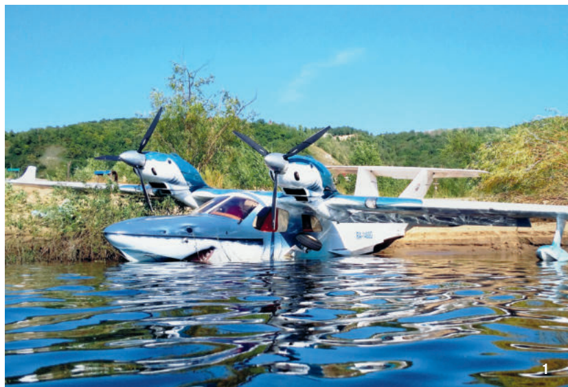
1: Die Chaika L-44 ist ein zweimotoriges (2x Rotax 914) Amphibium mit viel Platz für 4 Personen und guten Reiseeigenschaften (110 kn Reisegeschwindigkeit, über 1000 nm Reichweite).
