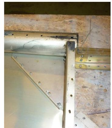
Bild 2) Lose Nieten (Abtrieb)
