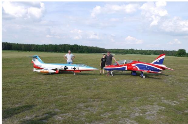
Die Hawk in einer fantastischen, hochglänzenden Sonderlackierung hat eine Spannweite von 3,8 m, eine Rumpflänge von 4,5 m und eine max. Abflugmasse von 92 kg. Angetrieben wird sie von einer Turbine mit 550 N Schub und hat damit ausgewogene und sehr realistische Flugeigenschaften. Die gesamte eingesetzte technische Ausrüstung ist auf dem besten derzeitigen Stand und den Flugleistungen eines solchen Großmodelles angemessen.
