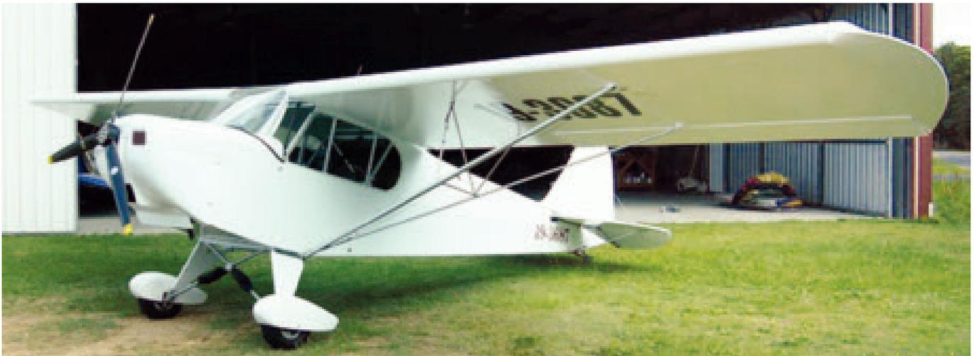
202 Koala wird mit verschiedenen Motoren angeboten, u. a. Hirth-Motoren, zwischen 28 und 40 PS. Herstellerangaben zufolge soll die Koala in der einfachsten Motorisierungsvariante ein Leergewicht von 113,4 kg ha-
