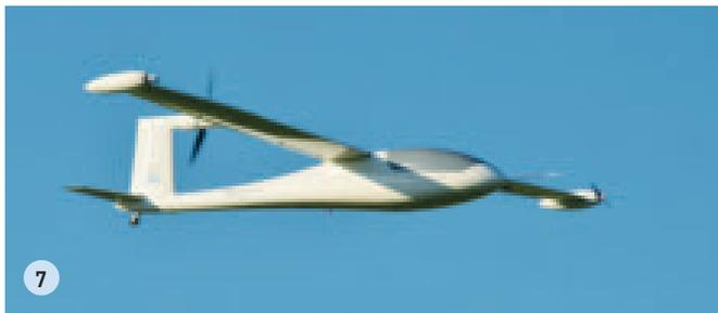
6: Um Untersuchungen für Modellversuche zu starten, wurde ein 4,60 Meter-Modell entwickelt und gefertigt. In der ersten Phase erhielt das e-Genius Mod nur normale Winglets.
