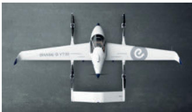
Ehangs VT-30 ist eine Art Hybrid aus Starrflügel mit vier Doppelrotoren für Start und Landung. im Reiseflug werden die Rotoren in Flugrichtung gedreht.
