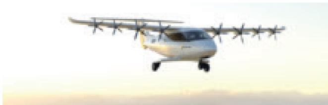
Um unter anderem die Anzahl der Fehlerquellen zu reduzieren, versuchen Hersteller normalerweise möglichst wenige Triebwerke zu installieren. Mit der „Blown-Lift“-Technologie werden so viele Motoren wie möglich verwendet.
