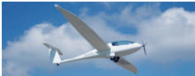
Der UL-Motorsegler Taurus, hier noch mit starrem Testpropeller, könnte bald Schule machen. Geigers HPD 40 scheint sich auch hier zu bewähren. Kühlluft holt sich das Triebwerk durch zwei NACA-Einläufe. Foto: Hellmut Penner
