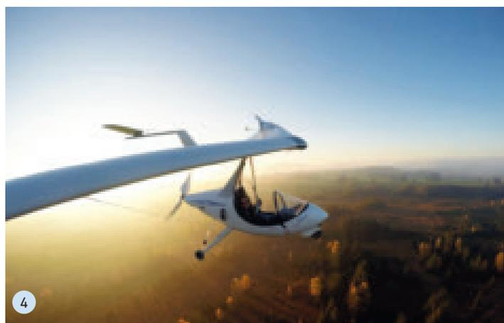
Toni Roth kurze Zeit später ein einfaches Trike und dazu einen leichten E-Antrieb mit einem Schnellwechselsystem, um vom Verbrenner (Polini-Motor) auf einen Elektroantrieb in Sekundenschnelle umrüsten zu können. Zwei Quick-Pins mit doppelter Sicherung befestigen die nur 8,5 kg schwere E-Motoreinheit, an deren Welle ein falt-Schubpropeller befestigt ist. Einfacher geht es nicht! Und heute ist es eigentlich Standard bei den meisten E-Trikes.
