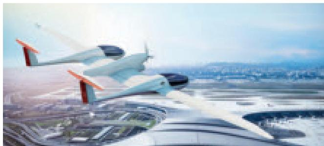
HY4 des DLR ist Musterbeispiel zur Untersuchung zukünftiger Antriebssysteme mit Wasserstoff-Brennstoffzellen. In Merzbrück bei Aachen entsteht eine neue Art von Forschungsflugplatz
