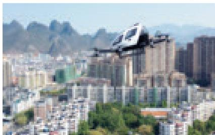
Nach Modelldrohnen wagten die Chinesen den Bau bemannter Drohnen. EHang 216 kann autonom fliegen. Ihr Einsatz wurde erstmals erprobt
