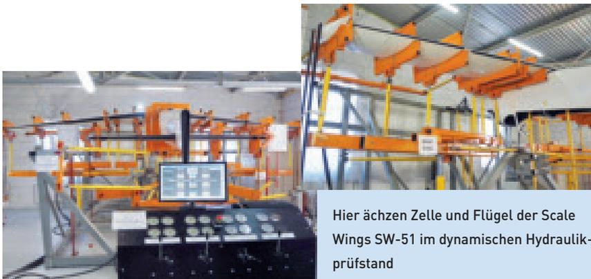
Hier ächzen Zelle und Flügel der Scale Wings SW-51 im dynamischen Hydraulikprüfstand
