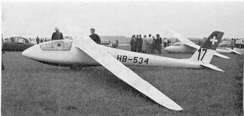
Hochleistungseinsitzer Elfe III-M, eine Konstruktion von Dr. Pfenniger
