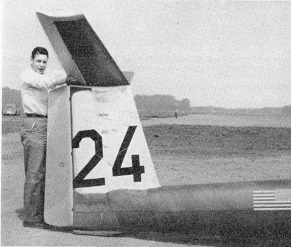
Dick Johnsons RHJ-6, auch „Mahagonibomber“ genannt (siehe auch THERMIK 1/1960 S. 15). Auffallende Merkmale die „bubble“-Haube (der zweite Sitz ist durch eine Klappe verschalt) und das T-Leitwerk mit V-Form. Unten rechts: Zwei im Profil — Mrs. Alice Johnson, die unermüdliche Helferin ihres Mannes und . . . der Flügelschnitt an der Wurzel. Wie schon berichtet, verwendete Johnson für sein Flugzeug Laminarprofile, die von dem Aerodynamiker Dr. Richard Eppler entworfen wurden.
