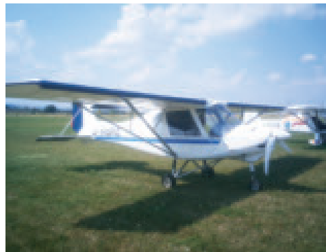
Lanitz Aviation lastet die C42 mit verstärktem Flügel und Oratex-Bespannung auf: 540/560 kg MTOW
