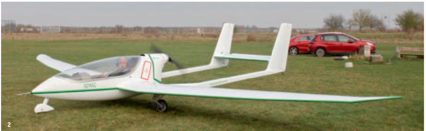
**Es ist eine Premiere, dass sich bei Flugleiterin Elena Rey der Pilot eines elektrisch angetriebenen Flugzeugs abflugbereit meldet. Dann gibt Vorführpilot Martin Steffen Strom. Der winzige Elektromotor hinter dem Pilotensitz leistet nominell nur 20 kW, doch dank überlegenem Drehmoment sind Elektromotoren im Vergleich zu Ottomotoren wahre Kraftmeier. Nach knapp 100 Metern Rollstrecke hebt das einsitzige Flugzeug ab und steigt flott zum Himmel.**
