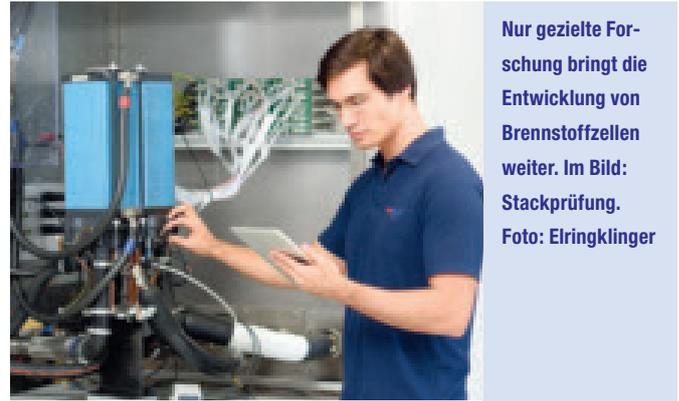
Nur gezielte Forschung bringt die Entwicklung von Brennstoffzellen weiter. Im Bild: Stackprüfung. Foto: Elingklinger
