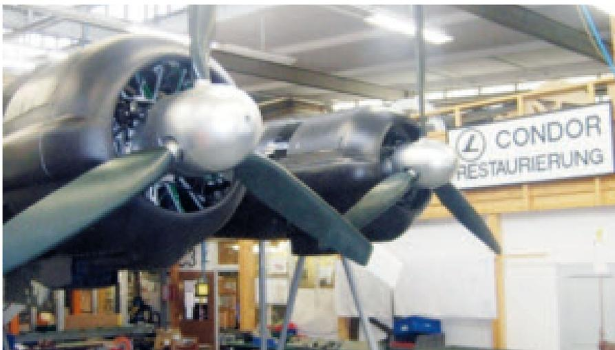
Fertiggestellter linker Außenflügel mit Triebwerken; Foto: FW 200 Condor Team Airbus Bremen
