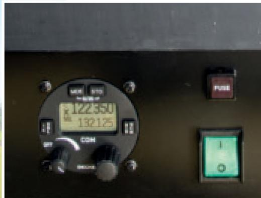
**Oben:** Bereits 2004 erschien ein dunkler Streifen am Horizont des Flugfunks in Europa: Mit der Verordnung des Europäischen Parlaments VO (EG) 552/2004 wurde die Pflicht zum Austausch der Flugfunkgeräte für das 8,33-KHz-Raster beschrieben.
