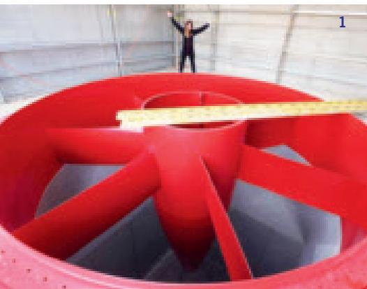
1: Montage des Aktivteils mit Einbaumotor und Laufradnabe
