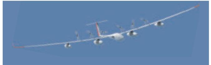
wettertauglich. Vier Pods unter dem Flügel dienen zur Aufnahme des Brennstoffzellen-Systems sowie für die Unterbringung der Sensor- und Kommunikationssysteme. Erfahrungen konnte Lange Research bereits mit dem für das DLR entwickelten Antares H2 sammeln. Die Fertigstellung der Antares E<sup>2</sup> soll noch in diesem Jahr erfolgen.
