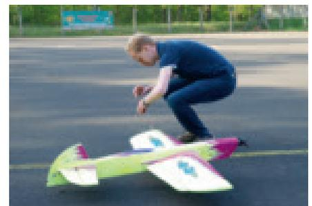
**Cornelius Gehrig bei der Startvorbereitung seines Modells. Ein paar technische Daten zum Modell: 152 cm Spannweite bei einem Gewicht von 1620 Gramm. Der eingebaute Motor hat einen Hubraum von 10 cm³.**
