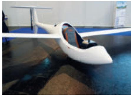
Selbststartender 120 kg- Einsitzer mit einer besten Gleitzahl von 40. Maximale Steigrate bis 3,5 m/s mit HPD 16.
