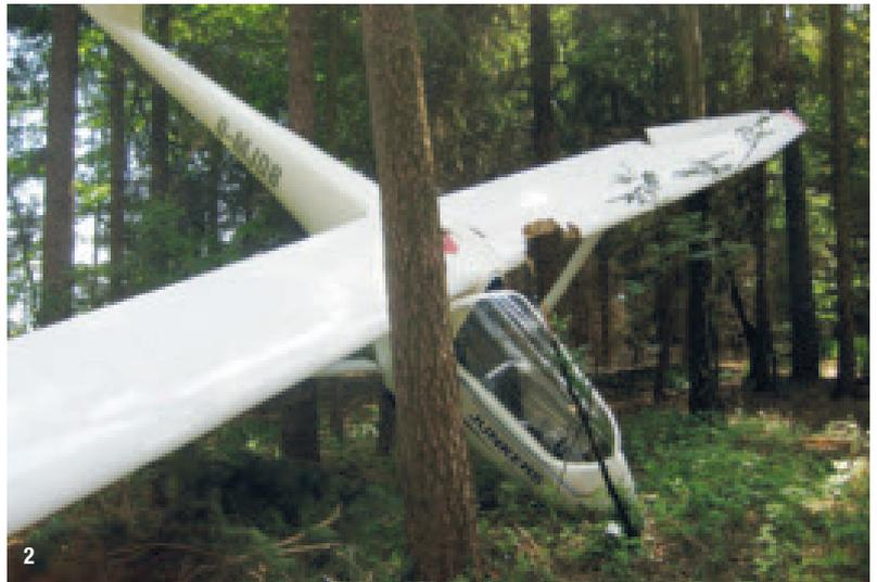
**1: Keine Baumlandung, sondern ein ausgelöstes Fallschirm-Gesamtrettungssystem, das Flugzeug und Pilot nach ungewolltem Absturz sicher zur Erde brachte. Der Fallschirm verfang sich in den Ästen und ließ den Segler durchfallen.**
