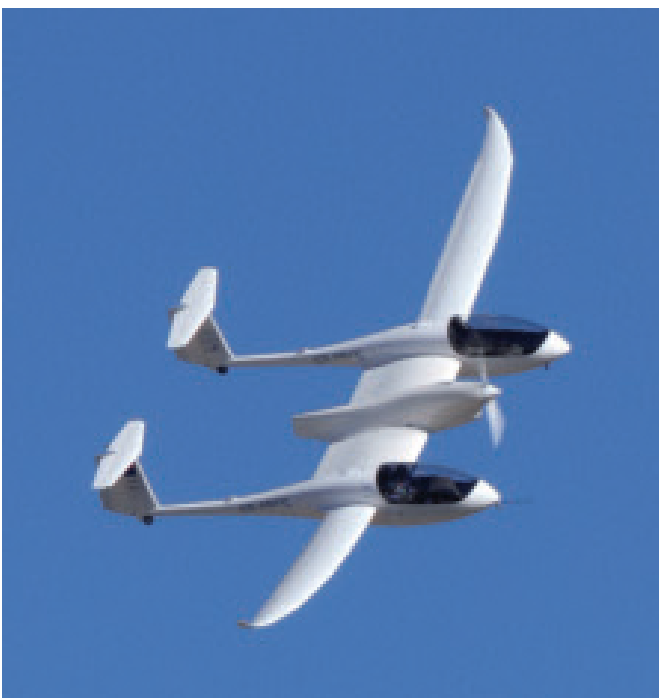
Das erste viersitzige Wasserstoff-Brennstoffzellen-Flugzeug des DLR in Stuttgart
