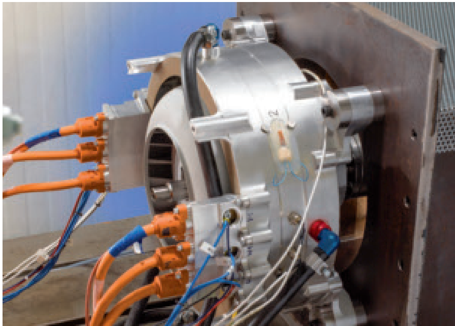
Der wassergekühlte 260-kW-Elektromotor auf einer Testbench
