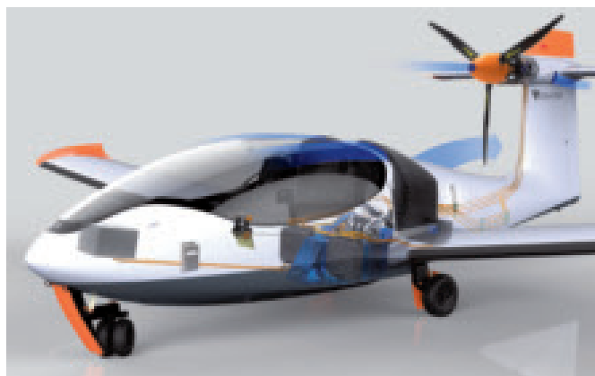
Hybridlösungen erfordern viele Kabelverbindungen.
