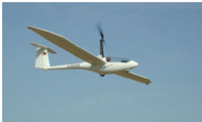
AE-I – erster Motorsegler mit Bleibatterien
