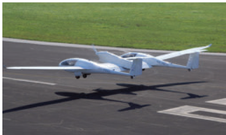
Erprobungsträger HY4 zur Erforschung der Wasserstoff-Brennstoffzellentechnik
